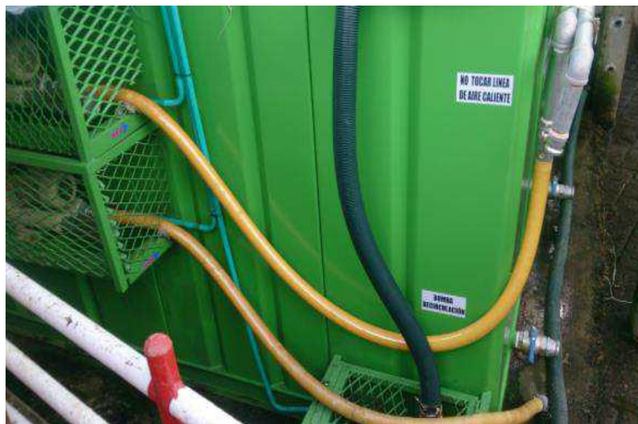
Fotografía 5. Líneas de aireación y recirculación, accionadas con aire de los sopladores industriales Fuente. Pasante del proyecto
