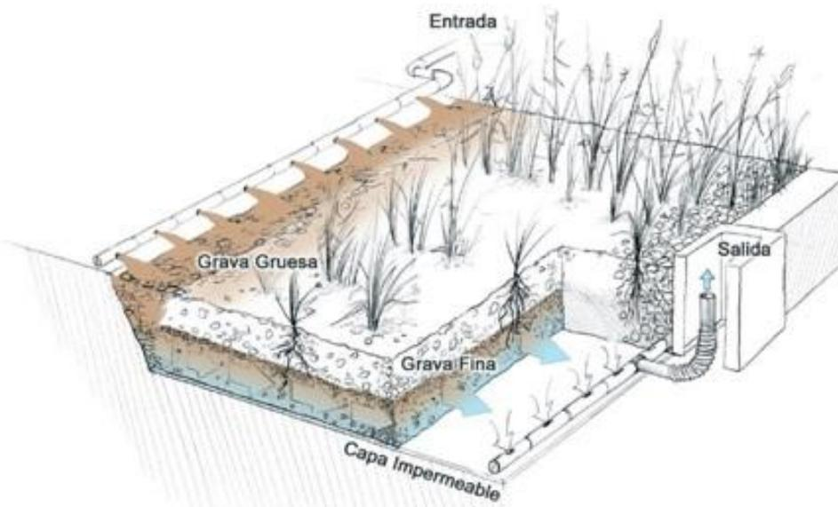
Figura 1. Esquema general del funcionamiento y elementos de un Humedal Artificial (Remtavares, 2013).
