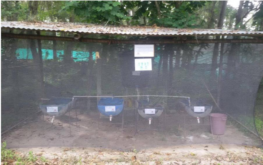
Figura 11. Sistema de humedal artificial superficial construido en el vivero de la UFPSO
