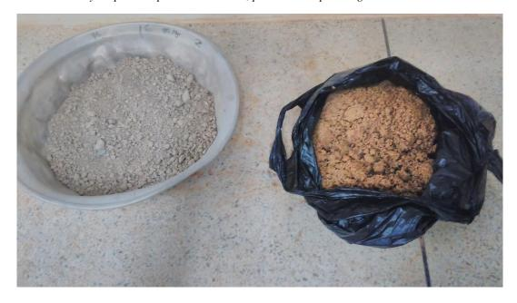
**Figura 35.**Prueba granulométrica realizada a 1500 gr de muestra de suelo.
