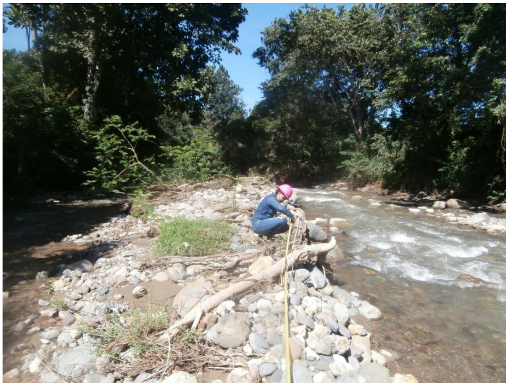
Fotografía 20: Demarcando las medidas para realizar el aforo
