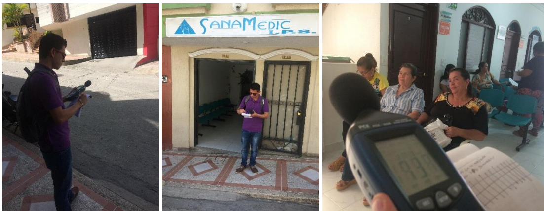
Medición de ruido ambiental con Sonómetro PCE-322A en las instalaciones de la IPS
