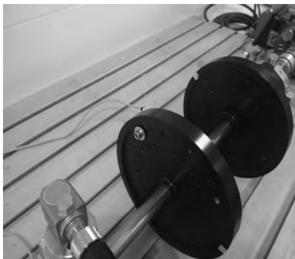
Imagen 5. Simulación de falla por desbalanceo dinámico.
