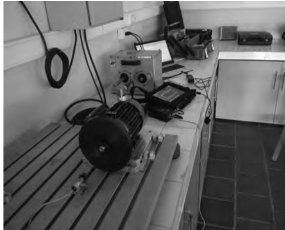
Imagen 4. Equipo de mediciones para prueba de vibración.
