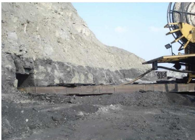
**Figura 3.** Proceso de minado, introducción de vigas en veta de carbón. Fuente: Autor del proyecto.
