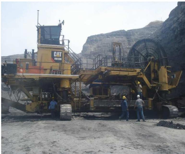
**Figura 2.** Highwall Mining 300. Fuente: Autor del proyecto.
