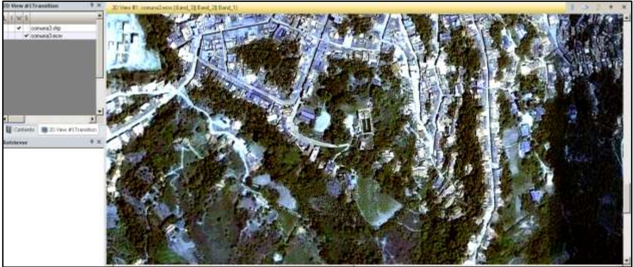
Figura 33. Procesamiento de imagen de satélite para identificación de estructura y su digitalización
