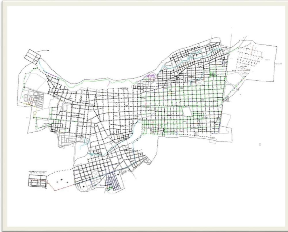
Figura 15. Plano general de la red de alcantarillado del municipio de Aguachica. Fuente. Empresa de Servicios Públicos de Aguachica.
