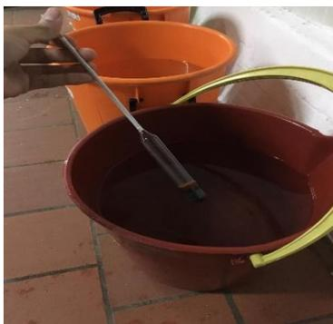
**Figura 51. Densímetro con escala de 1.000 a 1.100 g/ml.**
