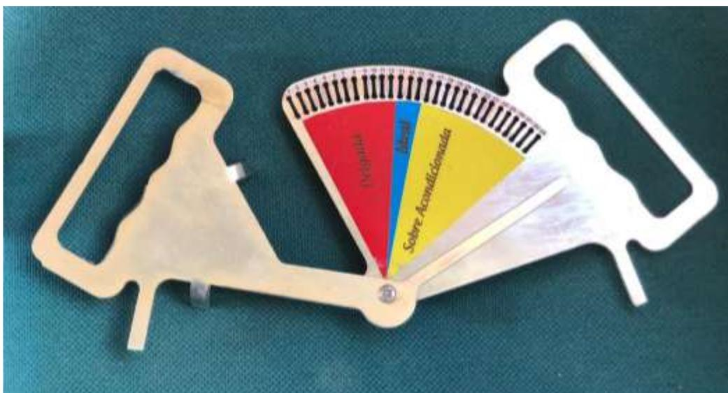
*Figura 2. Caliper (Fuente: Elaboración propia)*
