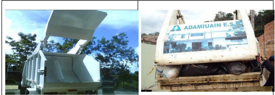
Fotografía 3. Equipos que cargan por la parte trasera
