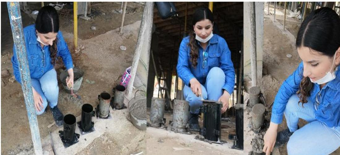
Finalmente, tras la compactación se completaba el llenado del molde con más mezcla y se alisaba la superficie con la ayuda del palustre para que la superficie quedara uniforme. Después de tener el concreto en los moldes se dejaban en un sitio cubierto evitando golpes o vibraciones, pasadas las 24 horas se retiraban del molde cuidadosamente y se marcaban, como se muestra en la Figura 25. Los resultados de laboratorio se muestran en el Apéndice F.
