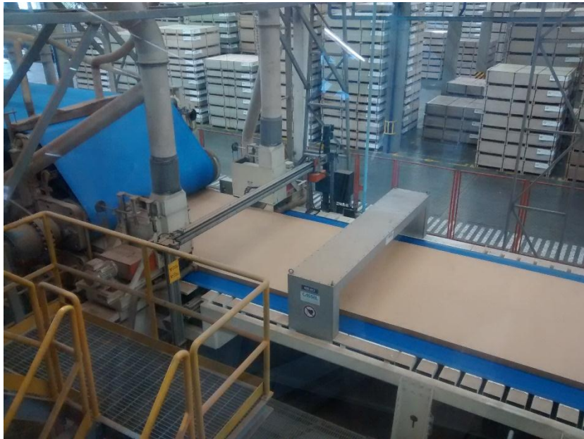
Figura 12. Manta de fibra saliendo de pre prensado. Fuente: Autor del proyecto.
