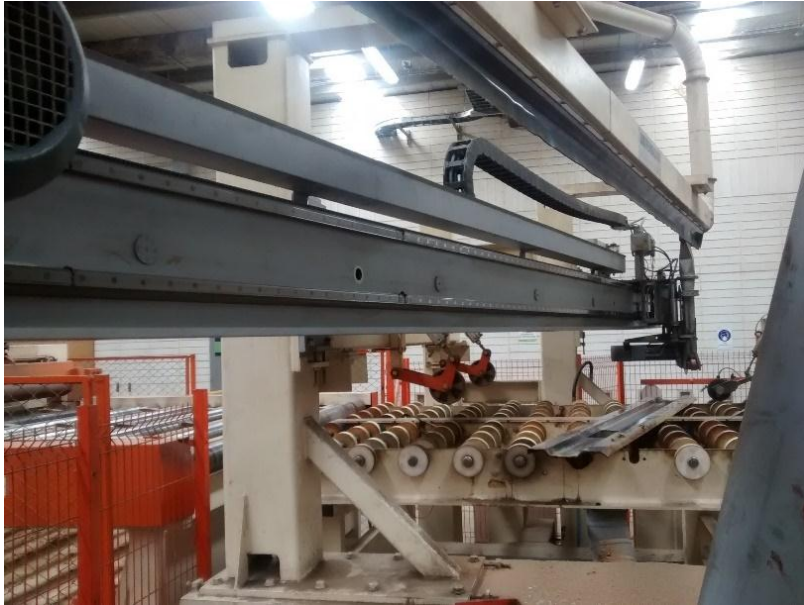
Figura 13. Sierra diagonal. Fuente: Autor del proyecto.
