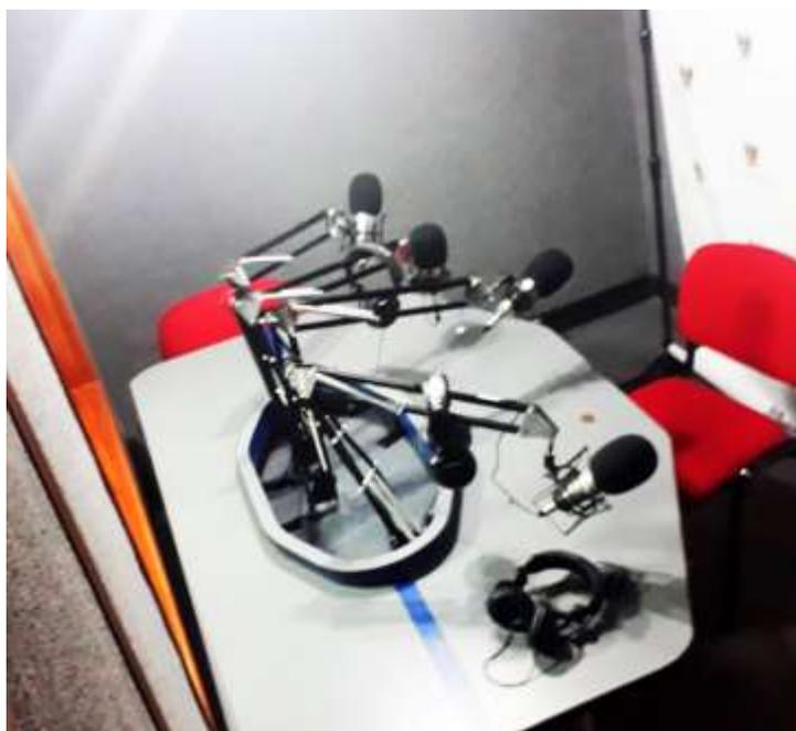
**Figura 5.** Cabina de radio con problemas de insonorización y reverberación.
