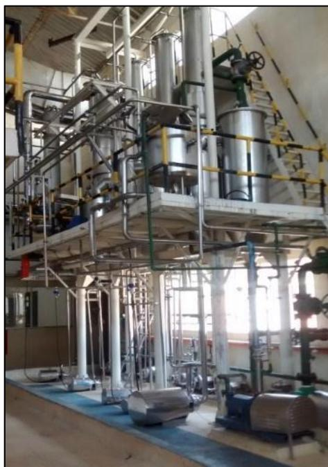
Figura 15. Evaporador de 4 efectos. Fuente. Autor
