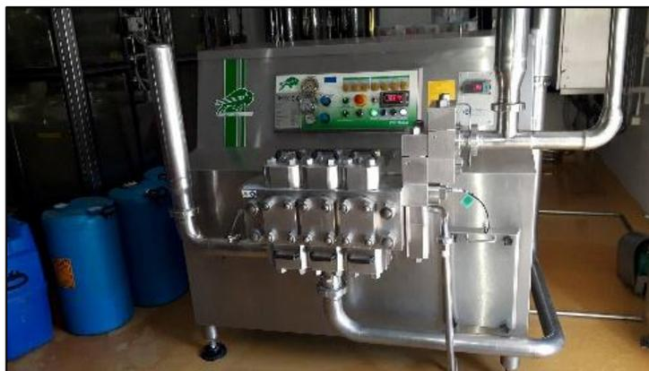
Figura 12. Homogeneizador FBF de capacidad 10.000 Lts/h. Fuente. Autor
