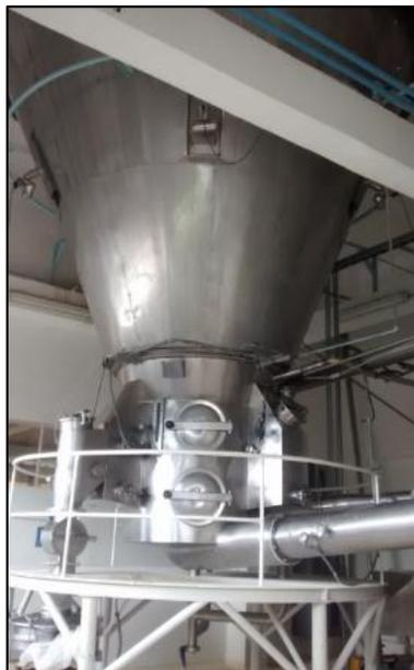
Figura 16. Máquina se secado spray marca IAF. Fuente. Autor
