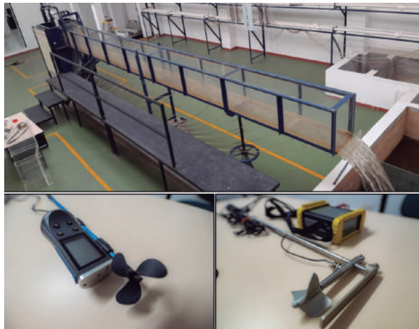
Figura 9. Banco de flujo libre y equipos usados en la práctica
