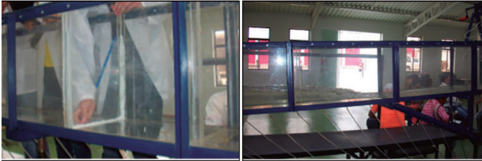
Figura 54. Instalación vertedero – flujo sobre canal con pendiente fuerte
