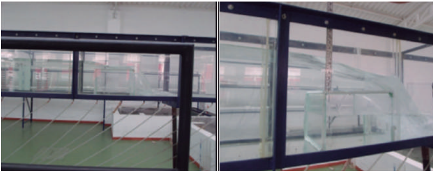
Figura 14. Flujo estable sobre el sistema – toma de lecturas sobre el escalón
