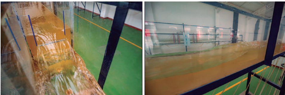
Figura 53. Vertedero – flujo sobre el canal con pendiente suave
