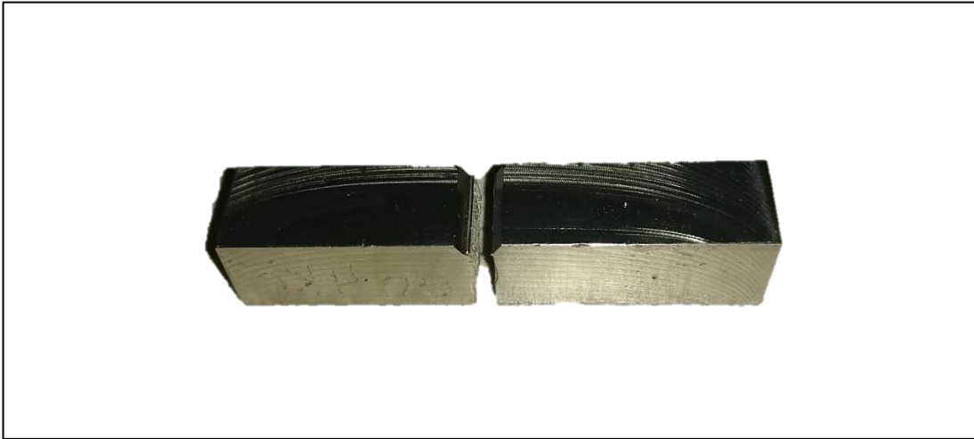
Figura 30. Resultado prueba de impacto muestra con tratamiento térmico 2.
