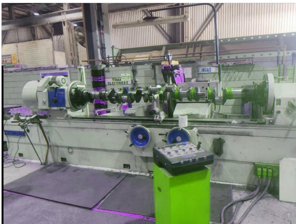
Apéndice F. Proceso de rectificación de Cigüeñal.
