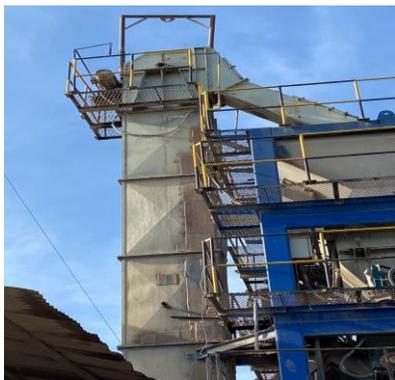
A través de cangilones lleva el material suministrado por los sinfines hacia la parte superior donde está la tolva de acopio o agregados.
