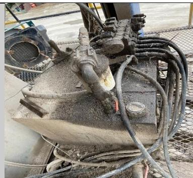
La unidad hidráulica tiene 5 conexiones, alimenta a 110 v a través de bobinas, estas conexiones son: pesaje de asfalto, compuertas de agregados, compuertas mezclador, pesaje de agregados, descargue de asfalto.
