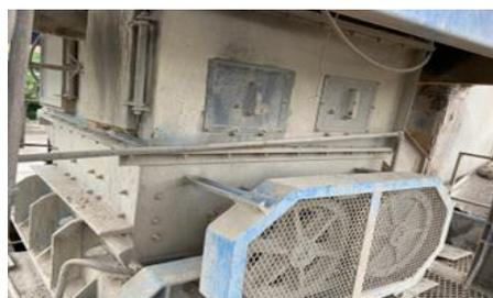
En el cae el material, el fino y la emulsión asfáltica para ser mezclado y tener como resultado la mezcla asfáltica y desembocar en las volquetas.
