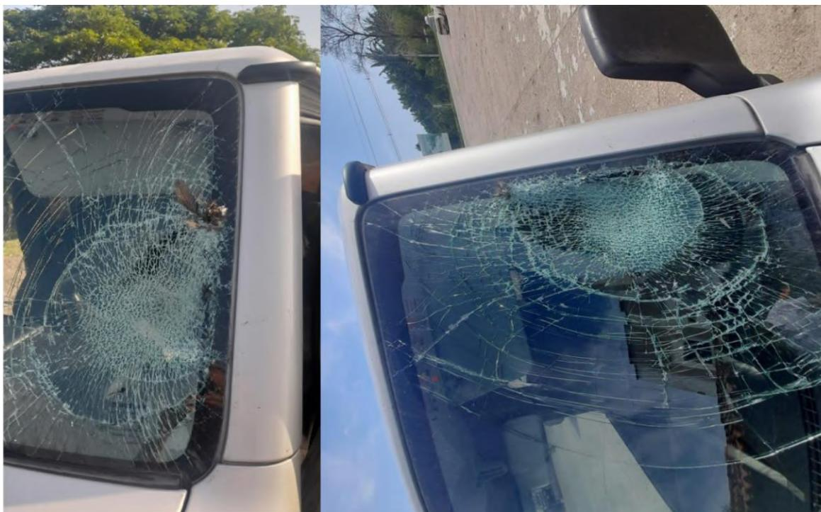
En esta figura (Figura 9) se puede observar un panorámico totalmente roto debido a un accidente, por lo tanto este incidente se tomó como prioridad a realizar su mantenimiento correctivo y a si tener nuevamente el vehículo operativo
