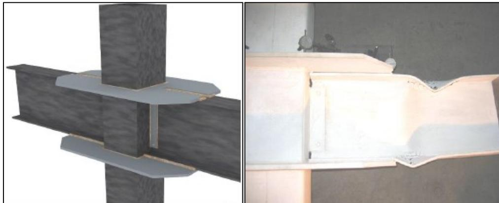
*Nota:* Tomado de Garza L. (2021)**2.3.4 Conexión Viga I a Columna I soldada con cubre placas**
