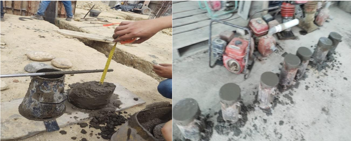
Figura 4. Toma de muestras de concreto
