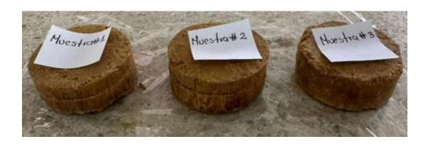
**Figura 43** *Ensayo de Corte Directo*
