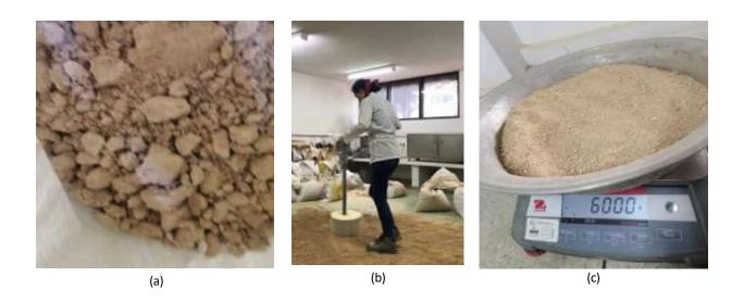
Nota: (a) Material antes de disgregar y homogenizar. (b) Proceso de disgregación con pisón. (c) Material homogenizado y disgregado.
