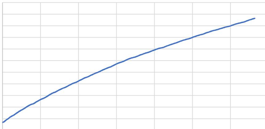
El límite de proporcionalidad corresponde a una fuerza  $P_1$  de 50,46 kN, o 50.460 daN, para obtener este valor se determina el punto en el cual termina la parte recta y comienza la parte curva del gráfico, la cual se encuentra marcado con una línea roja punteada y a una deformación de 0,296 mm.
