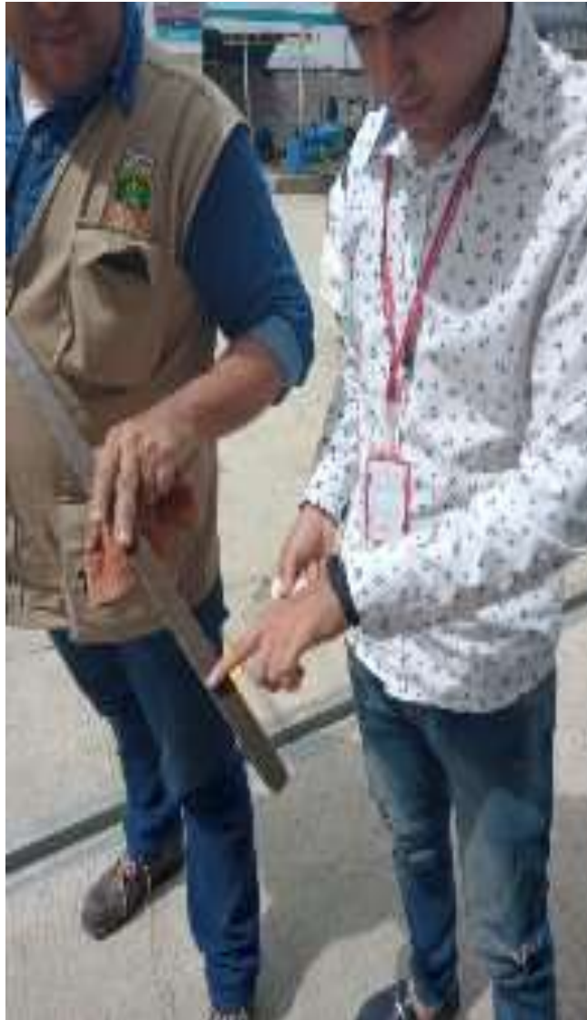
Figura 10. Realizando pruebas de existencia de agua en combustible. (2021). Fuente propia
