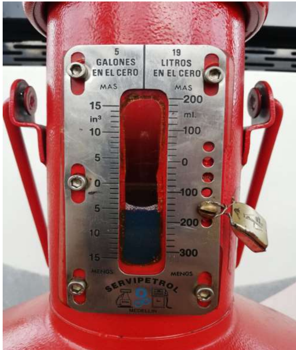
Figura 11. Serafín para calibración de los dispensadores de combustible. (2021). Fuente propia
