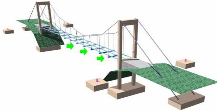
La colocación de las vigas primarias también se puede hacer mediante el sistema descrito anteriormente, aunque la instalación del resto de la plataforma no tiene mayor dificultad.
