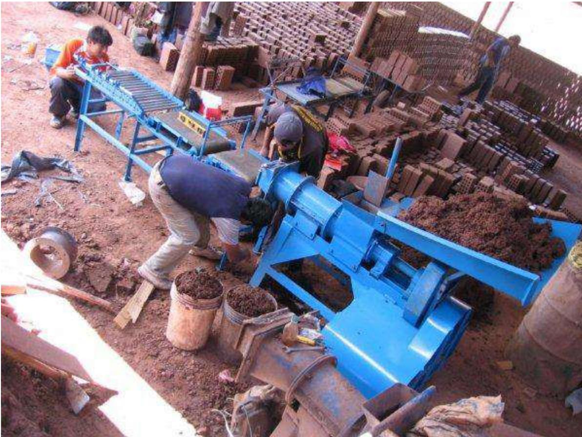
Figura 27. Extrusora de ladrillos
