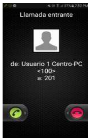
Figura 41. Prueba de llamada entre dos extensiones.
