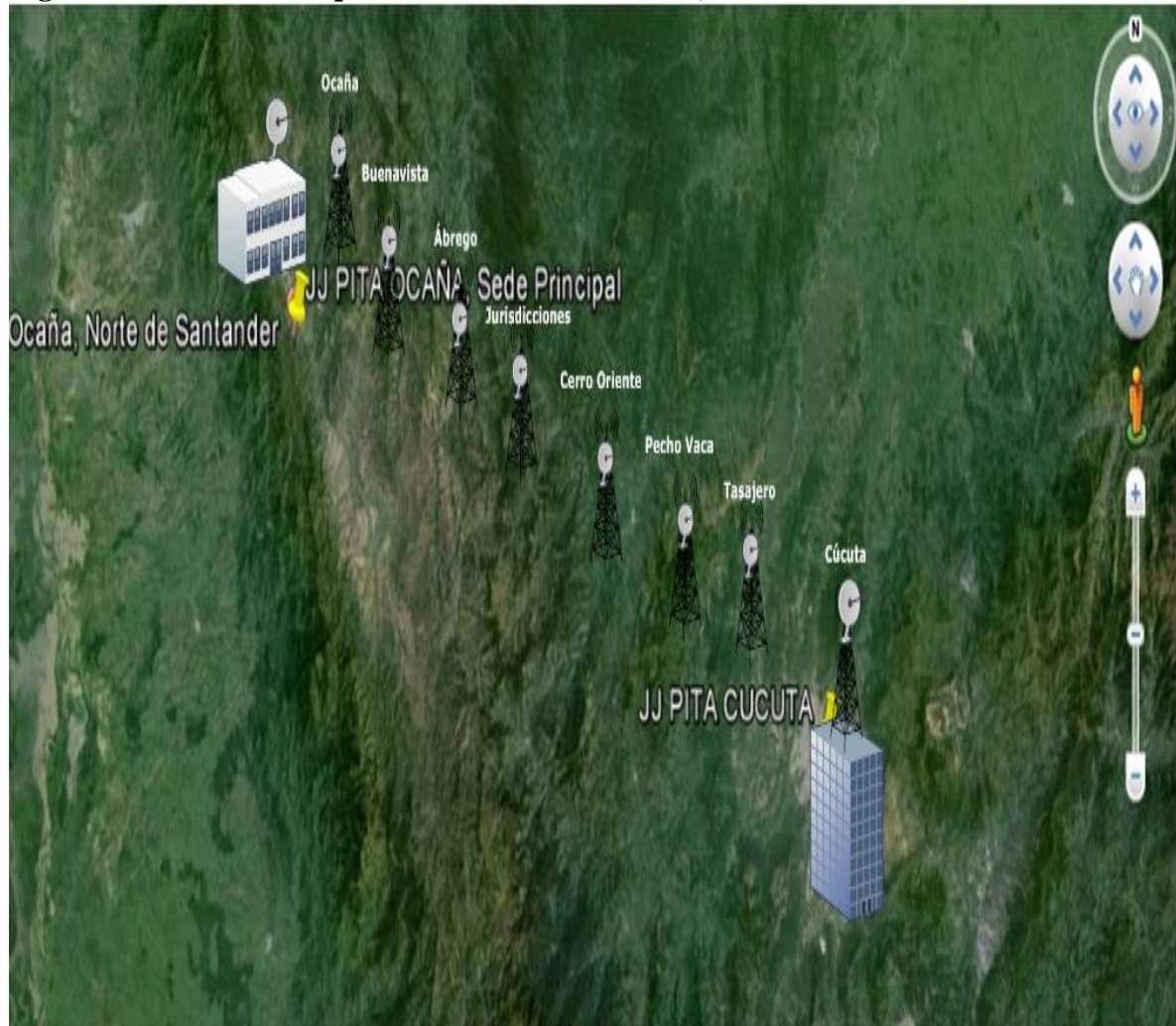
Figura 12. Red WLAN que interconecta a JJ PITA, Ocaña-Cúcuta
