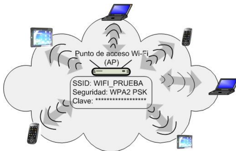
Figura 4. Modelo de una red WI-FI
