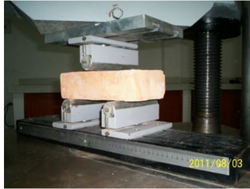
Figura 5 Flexión de ladrillos cerámicos. Autor (2020).
