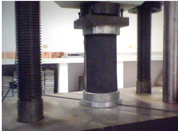
Figura 1 Compresión de cilindros normales de concreto. Autor (2020).
