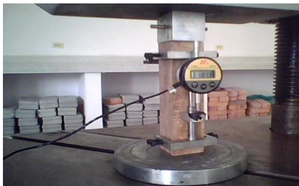
Figura 9 Compresión axial o paralela al grano. Autor (2020).
