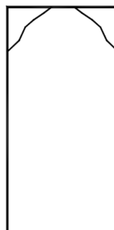
Figura 15 Falla tipo 6. NTC 673 (2010).
