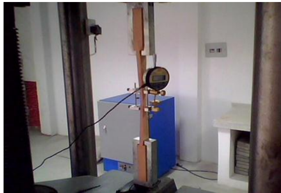
Figura 7 Tracción paralela al grano. Autor (2020).
