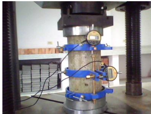
Figura 2 Compresión a concreto. Autor (2020).
