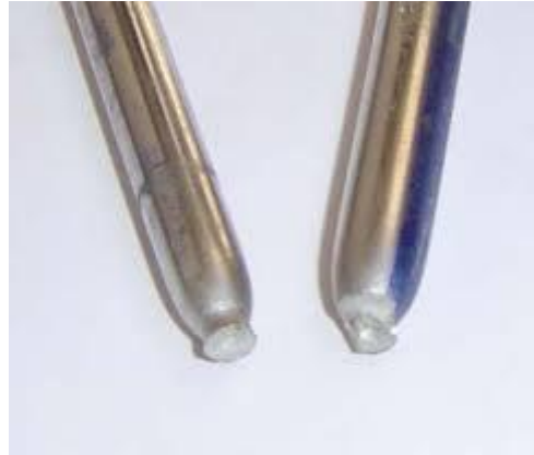
Figura 17 Falla Dúctil. Autor (2020).
