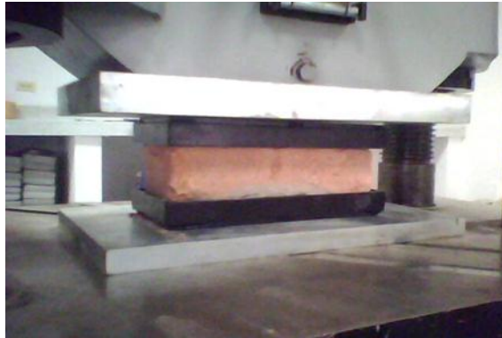
Figura 4 Compresión de ladrillos cerámicos. Autor (2020).
