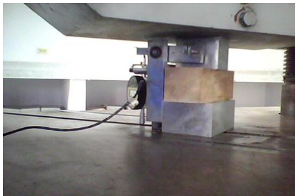
Figura 8 Compresión perpendicular al grano. Autor (2020).
