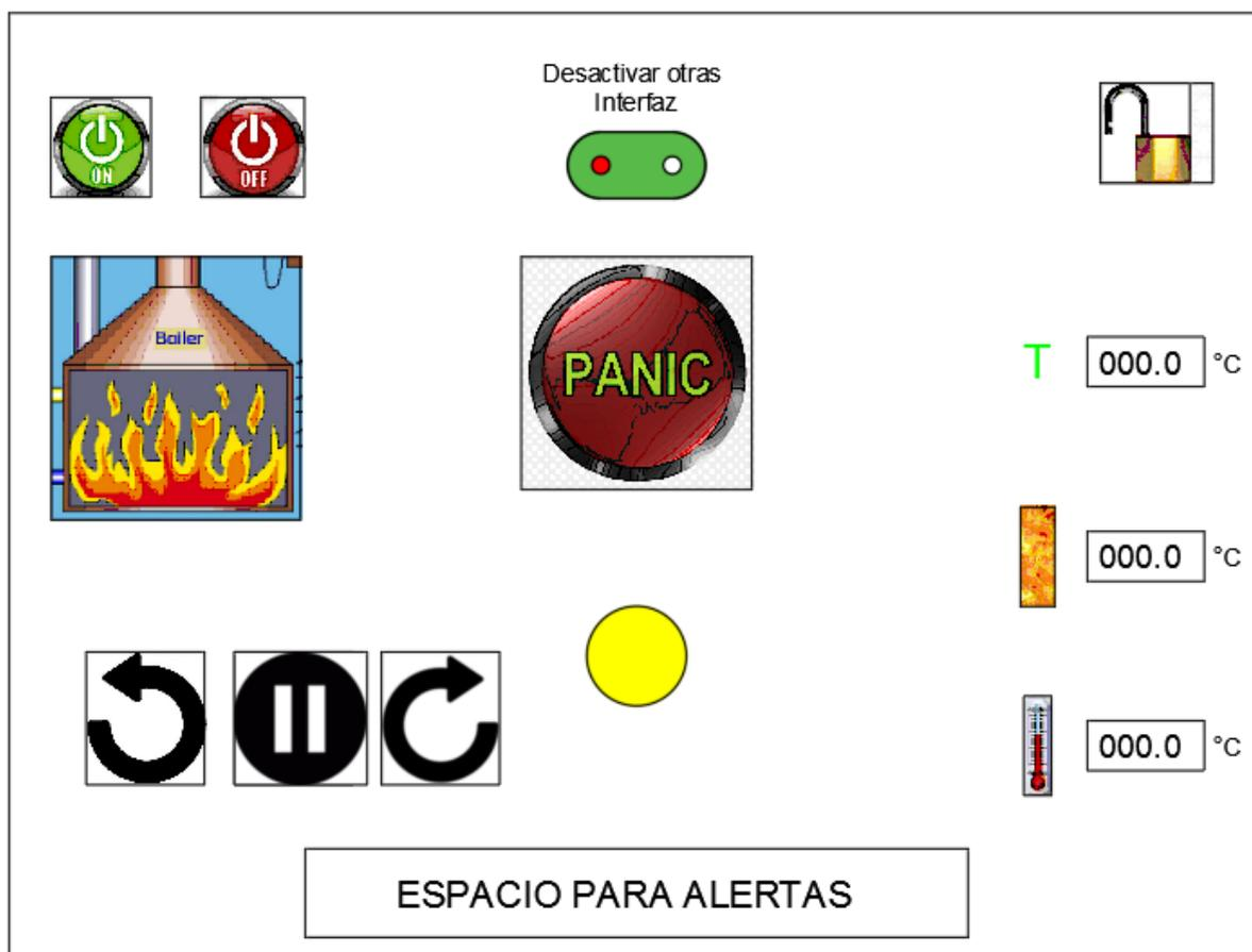
Figura 7. Interfaz para manejo y control del horno de crisol
