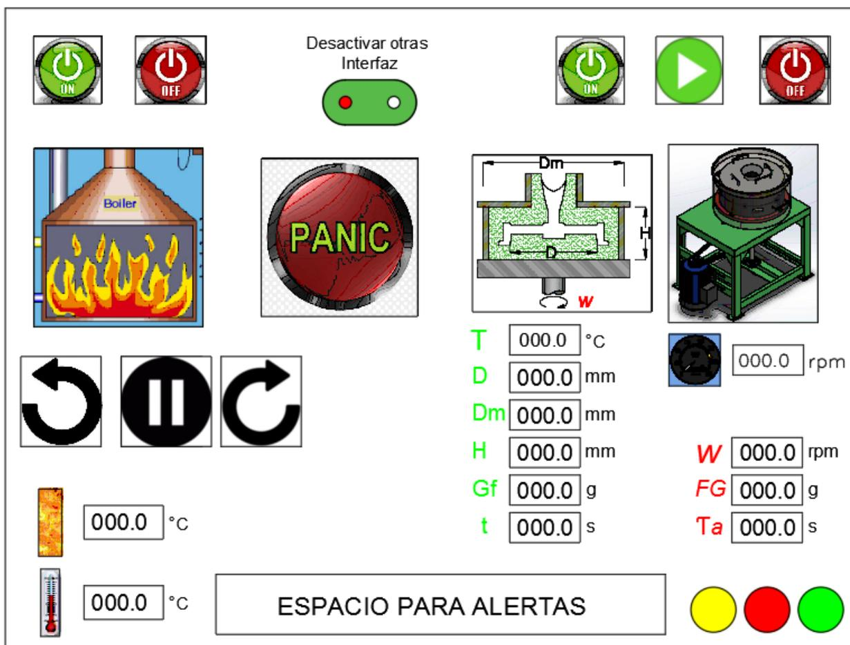
Figura 9. Interfaz para fundición semicentrífuga y centrifugado
