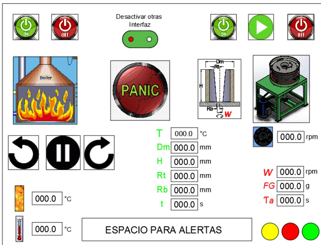
Figura 8. Interfaz para fundición centrifuga vertical
