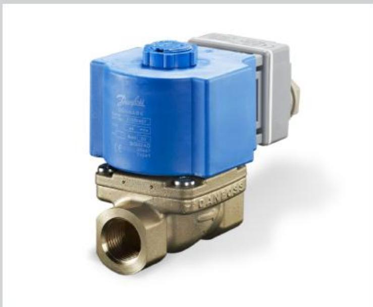
La gama EV260B se compone de válvulas solenoides servoaccionadas de 2 vías con función de modulación proporcional y conexiones de tamaños comprendidos entre 1/4" y 3/4". Mediante la regulación continua de la corriente de la bobina, es posible situar la armadura en cualquier posición del tubo de la armadura y, de este modo, ajustar la bobina entre las posiciones de cierre completo y apertura completa. La válvula se abre totalmente cuando la corriente de la bobina alcanza su máximo valor.
