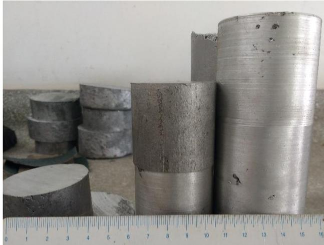
Figura 3. Piezas fundidas por colada estática en el taller de la UFPSO (escala en cm)
