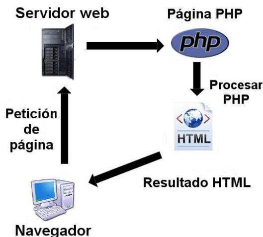
Figura 13. Ejemplo de un programa PHP ejecutado en el servidor.
