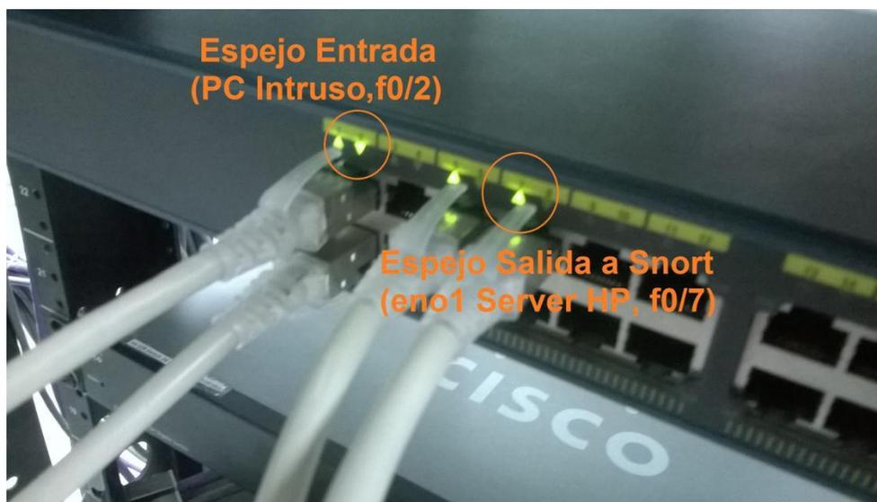
**Figura 80.** Interfaces f0/2 y f0/7 del Switch 1, Fuente: **Autores del Proyecto**
