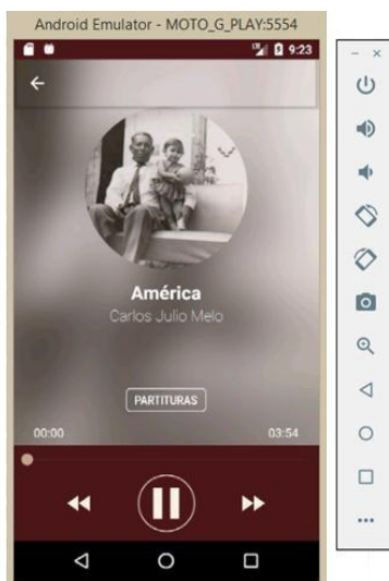
Figura 8. Emulador disponible en Android Studio que permite instalar y probar más rápido cualquier app en todos los equipos móviles disponibles gracias a sus AVD (dispositivos virtuales). Fuente: Autor del Proyecto
