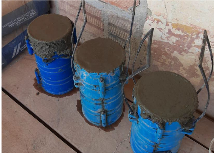
Figura 5. Extracción de cilindros para el concreto extendido. Autores 2022
