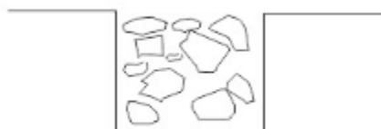
Figura 4. Esquema de cimentación en piedra trabada.
