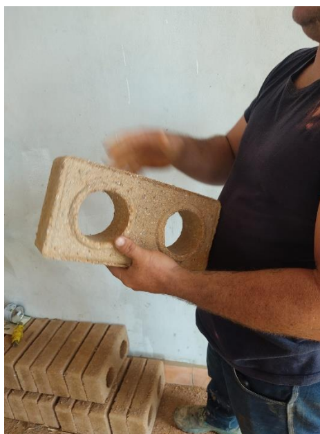
Figura 35. Bloque BTC para muros divisorios.
