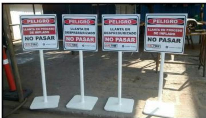
**Figura 37** Avisos de Peligro para demarcar cuando se presurice o despresurice una llanta.
