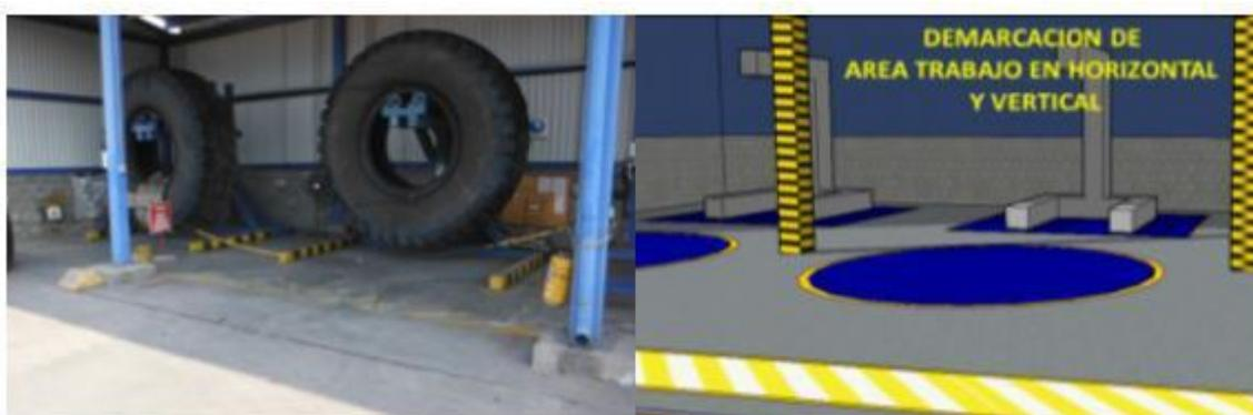
**Figura 27** Demarcación de área de reparación de llantas
