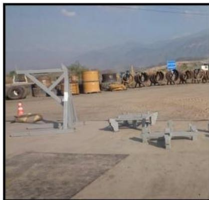
**Figura 35** Bases de soporte para rines y Base de limpieza.
