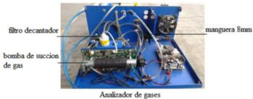
Figura 9. Analizador de gases
