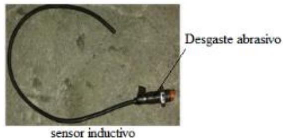
Figura 16. Desgaste abrasivo sensor inductivo
