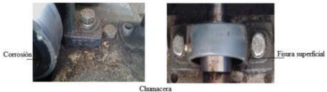
Figura 15. Fisura superficial, Corrosión.
