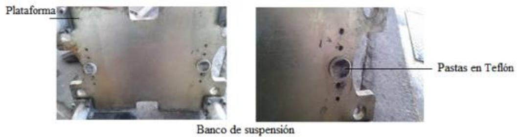
Figura 17. Teflón falla Abrasión
