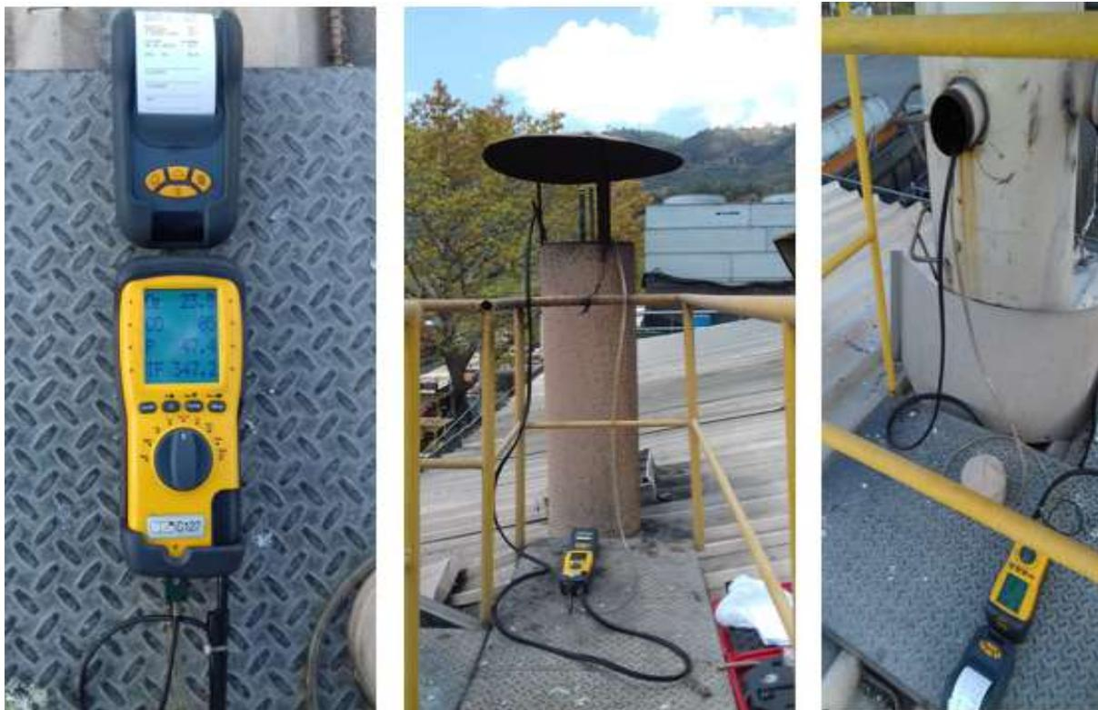
Figura 8. Análisis de gases para caldera de 100 BHP y 200 BHP.
