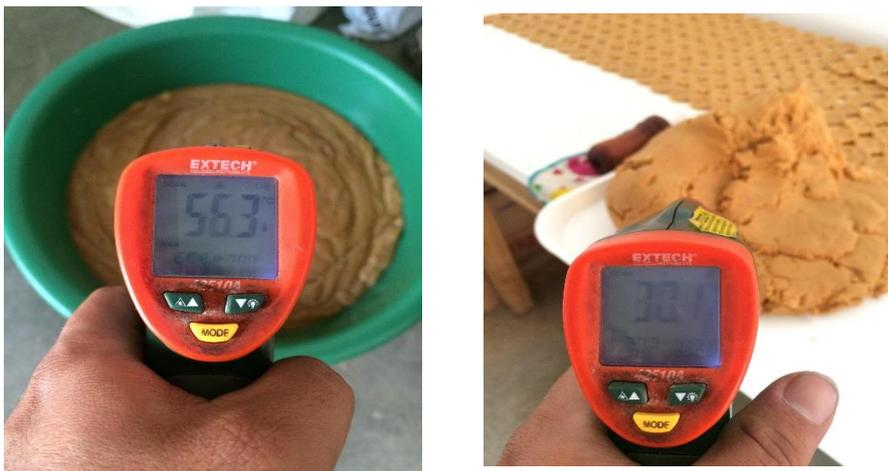
**Figura 43.** Medición con el pirómetro
