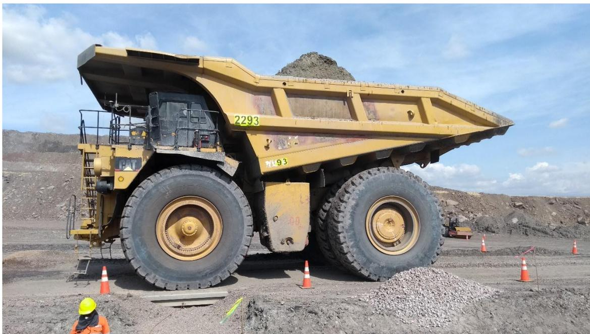
**Imagen 19.** Camión pesando eje delantero
