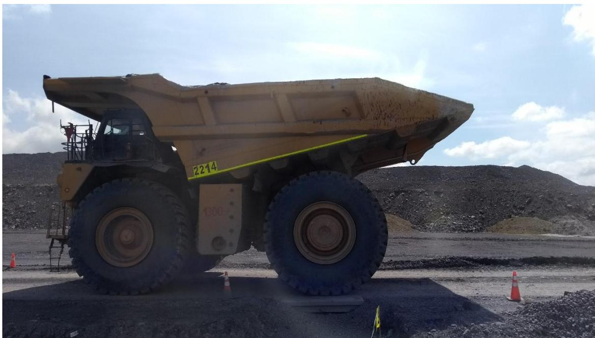
**Imagen 20.** Camión pesando eje trasero
