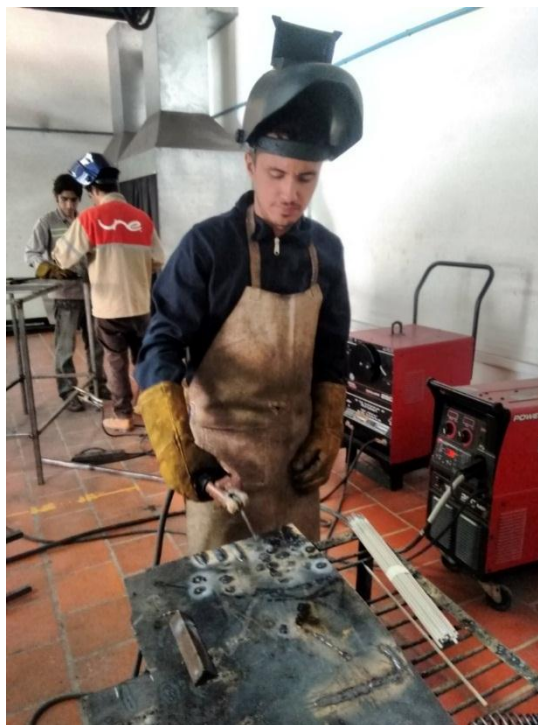
Figura 54. Se utilizaron electrodos de tipo AWS 6011 para soldar la estructura. Fuente: Autores del proyecto.
