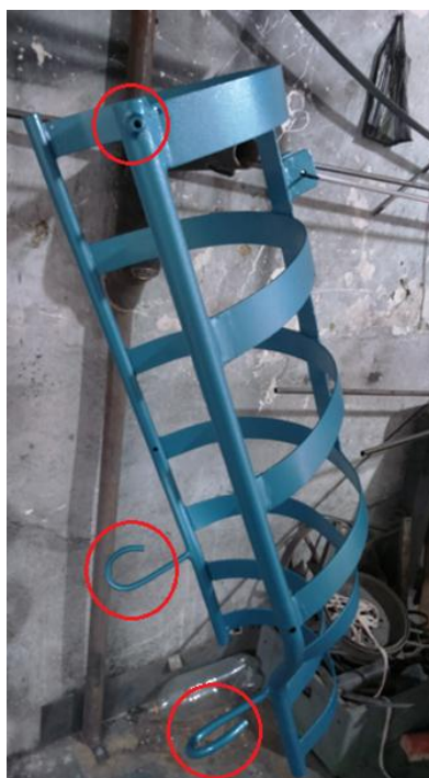
Figura 61. Acabado final de la parte superior de la camilla.
