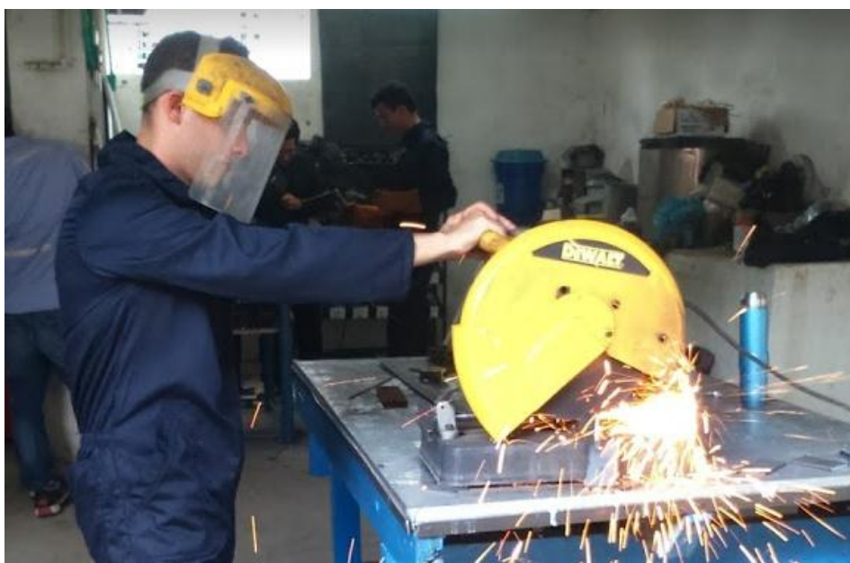
Figura 53. Corte de la tubería. Fuente: Autores del proyecto.
