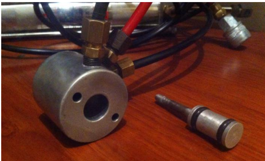
Figura 70. Válvula 4/2 de accionamiento manual. Fuente: Autores del proyecto.
