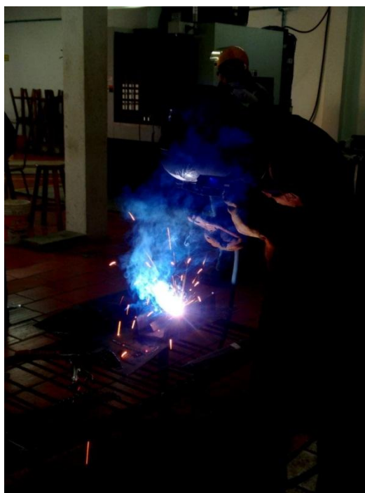
Figura 54. Se utilizaron electrodos de tipo AWS 6011 para soldar la estructura. Fuente: Autores del proyecto.
