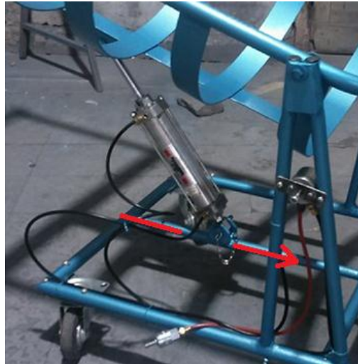
Figura 28. Grados de libertad de la unión corredera-guía. Fuente: Autores del proyecto.
