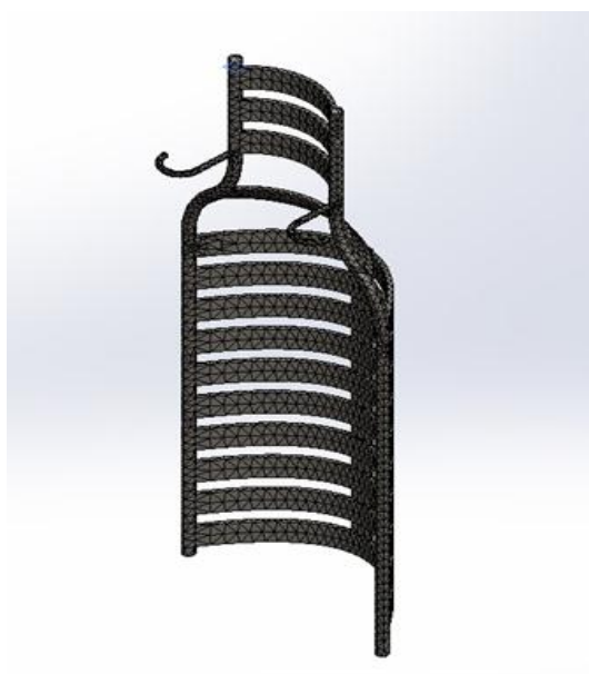
Figura 44. Mallado estándar de la camilla en SolidWorks.
