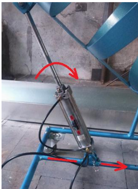
Figura 29. Grados de libertad de la unión pistón-corredera . Fuente: Autores del proyecto.
