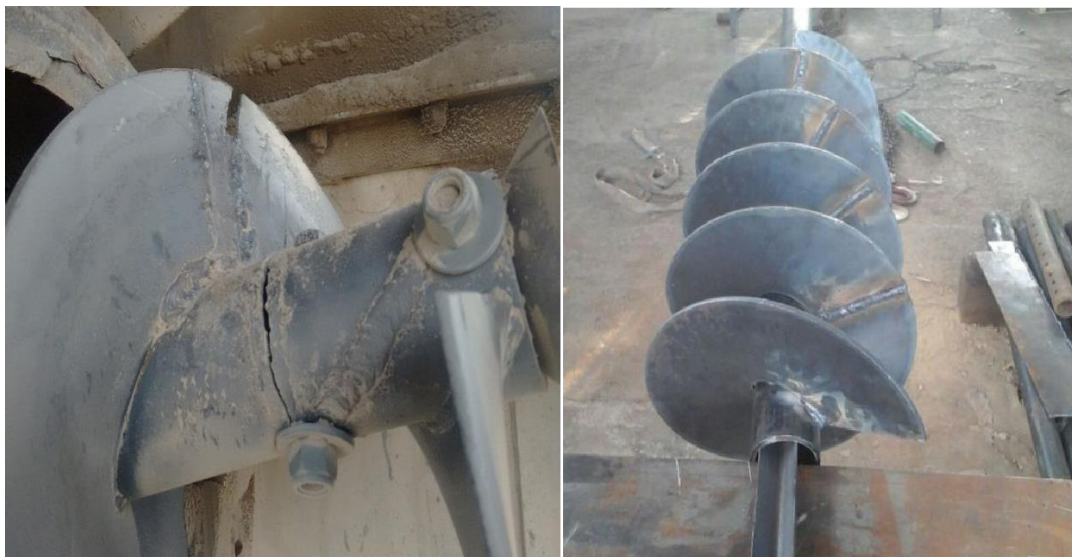
Figura 24. Falla recurrente del tornillo sin fin por agrietamiento y fabricación de un nuevo tornillo.
