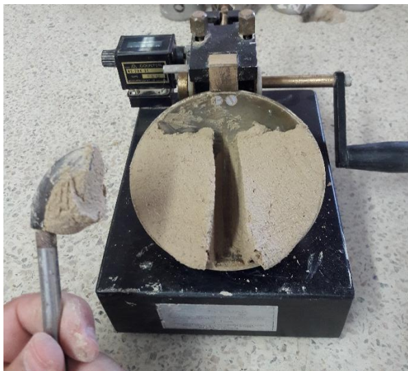
Figura 35. Corte a la muestra con el ranurador. Fuente: Elaboración propia.
