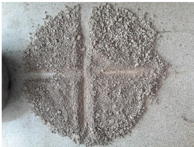
Figura 11. Cuarteo de la muestra de arcilla.
