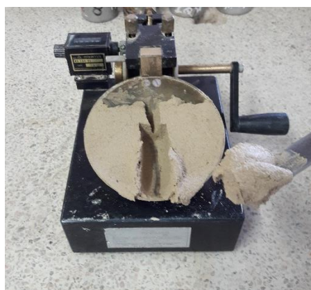
Figura 36. Muestra tomada en el cierre de la ranura. Fuente: Autor del proyecto
