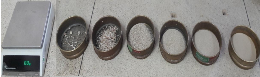
Figura 16. Peso de material retenido en los tamices. Fuente: Elaboración propia.
