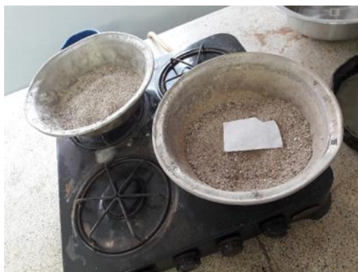
Figura 14. Secado del material retenido. Fuente: Autor del proyecto
