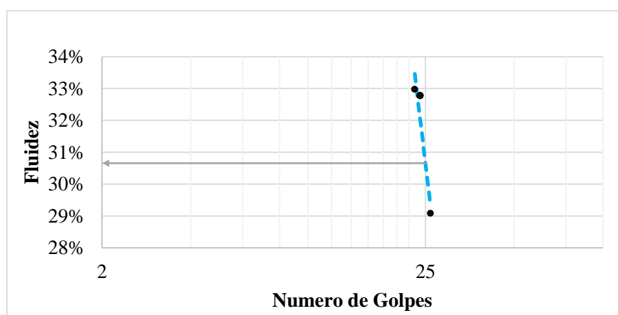
Figura 44. Curva de fluidez para la muestra 6.
