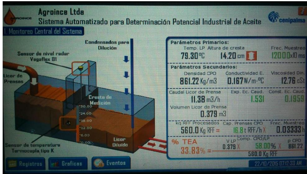
Imagen 5. Sistema automatizado para determinación potencial industrial de aceite.
