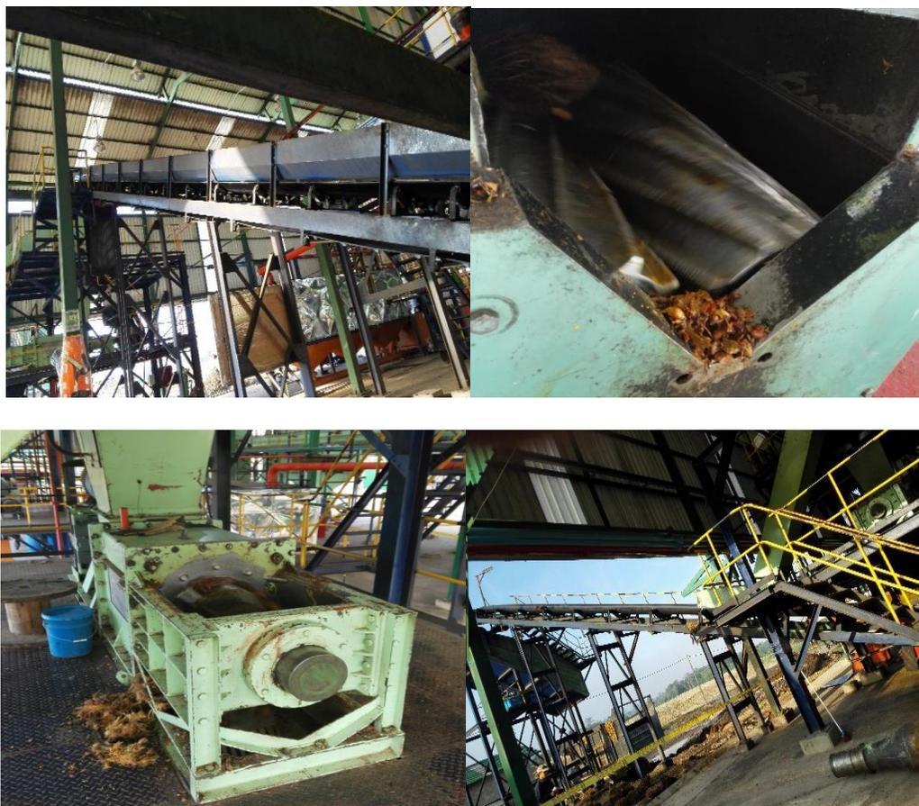
Fotografía 11. Banda para raquis – laminador – prensa de racimos vacíos – banda de racimos prensados. Fuente: El autor.
