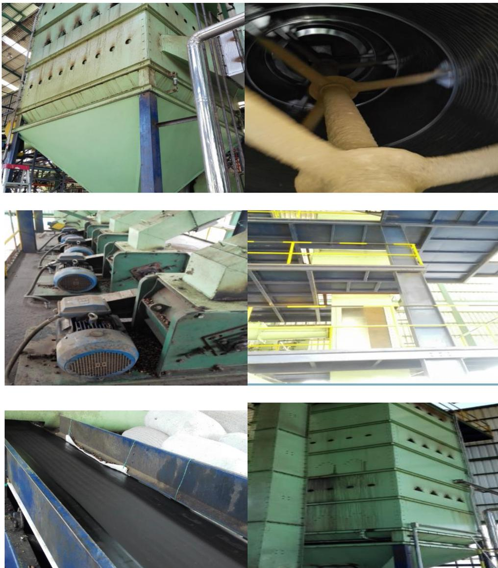
Fotografía 10. Silo de nuez – tambor clasificador – ripple mill – columna de separación de cascara – banda transportadora de almendra – silo de almendra. Fuente: El autor.
