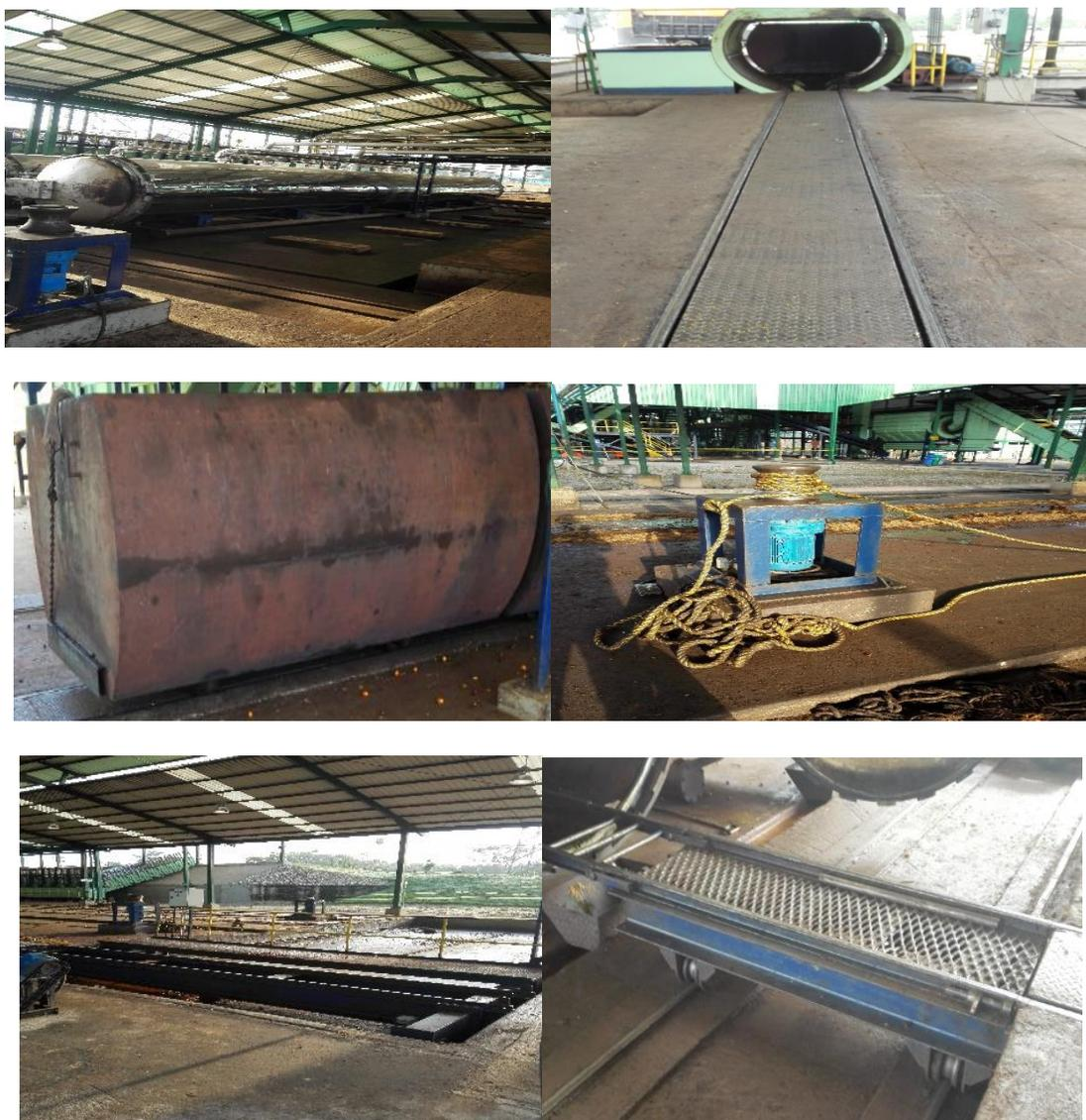
Fotografía 5. Autoclave, rielera, vagoneta, cabrestante, mesa de transferencia, puente de traslación. Fuente: El autor.
