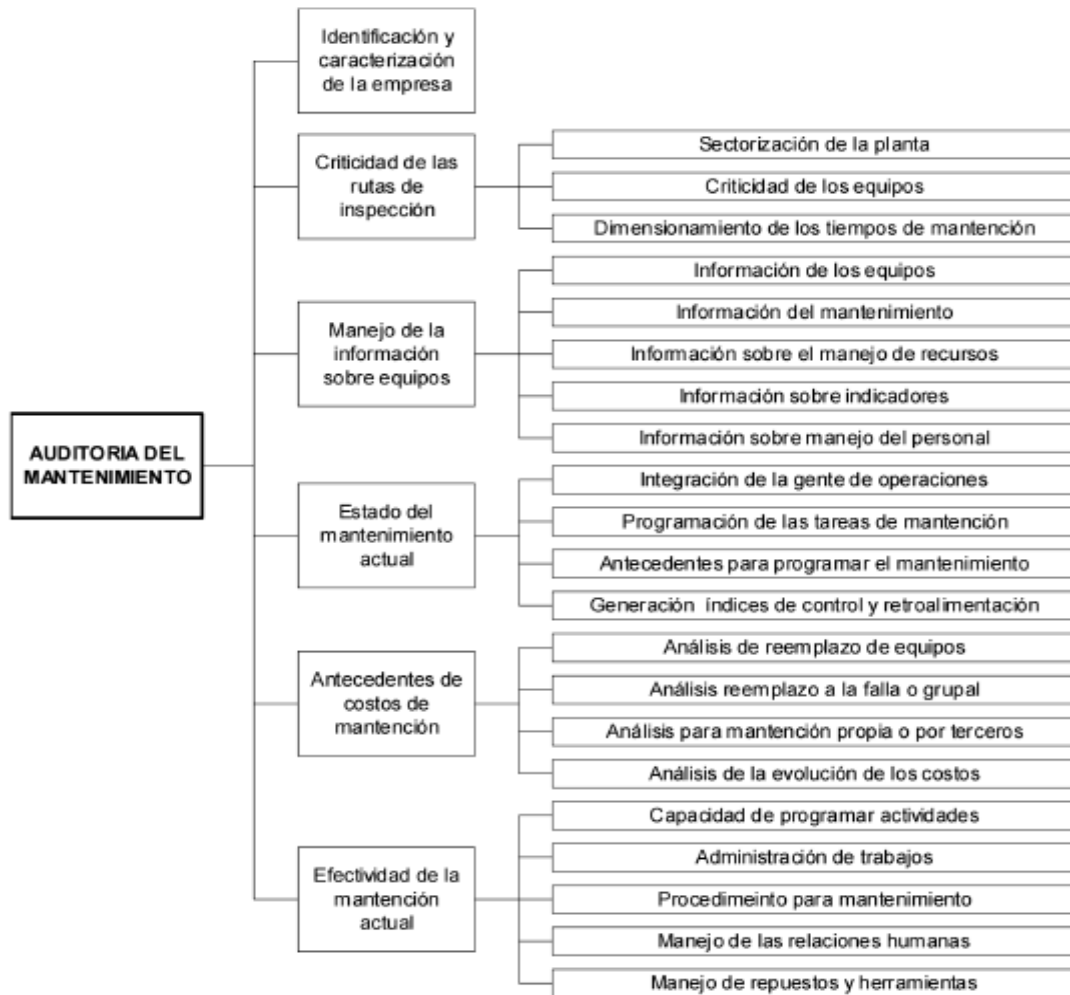
Figura 11. Aspectos de la auditoría de mantenimiento.
