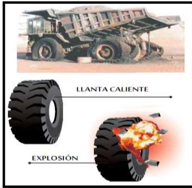
Figura 59. Explosión de neumáticos.
