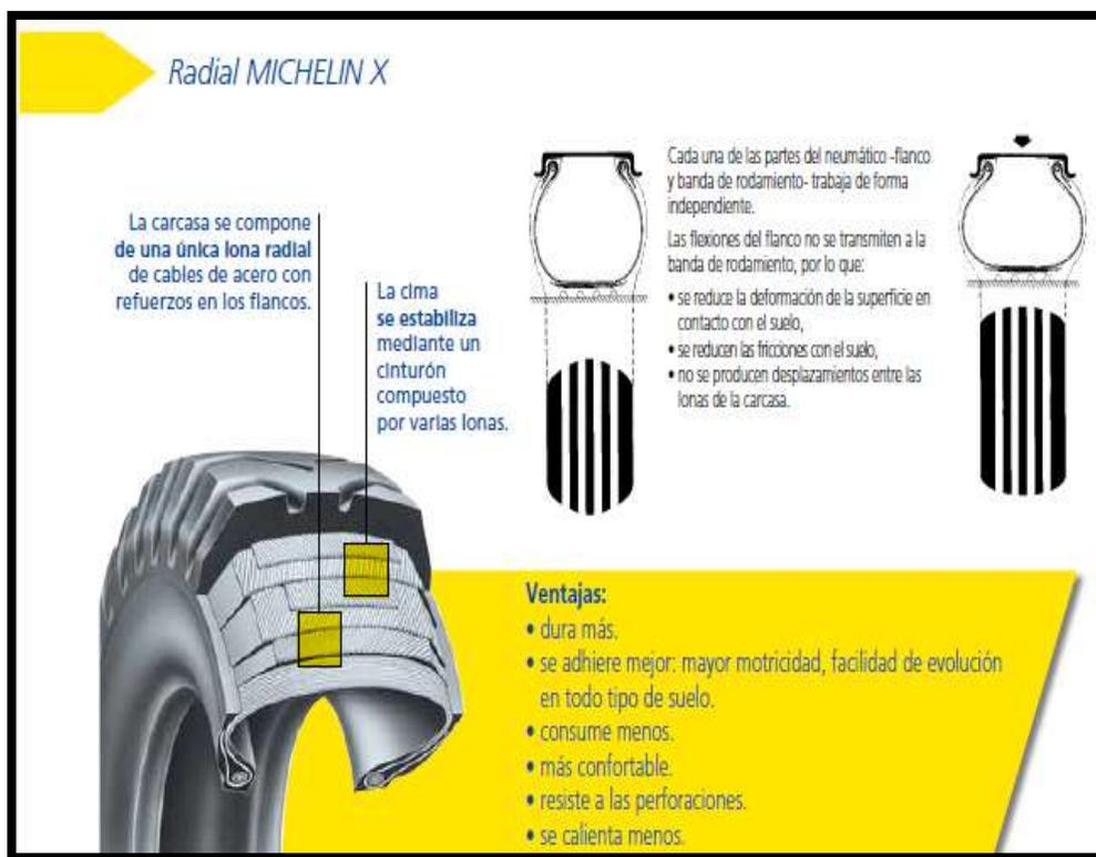
Figura 2. Neumático Radial
