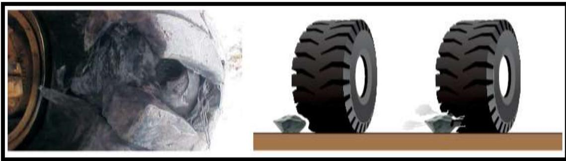
Figura 60. Estallido de llanta.
