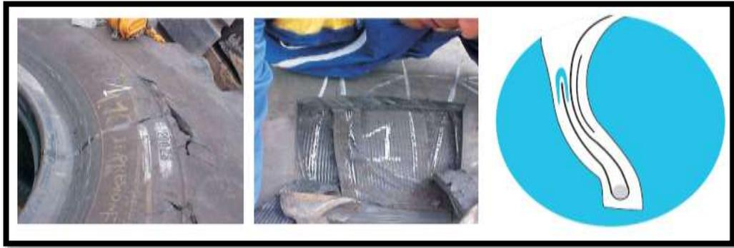
Figura 39. Separación mecánica en el costado.
