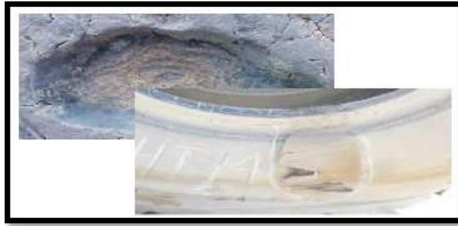
Figura 53. Desprendimiento de la reparación.
