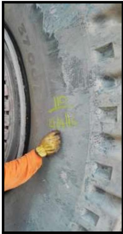
Fotografía 14. Impresión de presiones en llanta.
